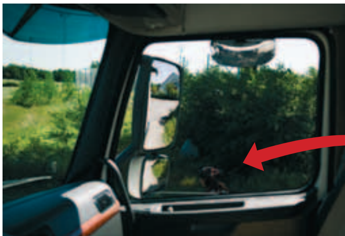
Billede 2.5: Chaufførens udsyn til cyklisten gennem sideruden i situationen på billede 2.4 (cyklisthøjde 1,5 m)
